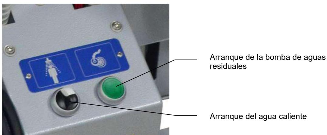
La bomba de aguas residuales puede encenderse manualmente manteniendo pulsado el interruptor "Arranque de la bomba de aguas residuales".
